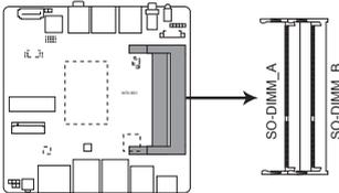
**NITX-BD1 204-pin DDR3L SO-DIMM sockets**
